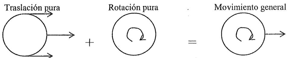
Por este motivo, la velocidad de cualquier punto  $P$  de un cuerpo rígido siempre se puede determinar como la suma de la velocidad con que se traslada un punto  $O$  cualquiera más la de rotación de  $P$  alrededor de ese punto  $O$ . En fórmulas:  $\vec{v}_p = \vec{v}_o + \vec{\Omega} \times \vec{r}_{p,o}$
