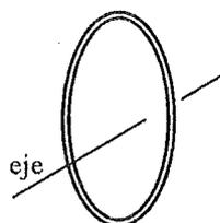
**Teorema de Steiner:** Este teorema permite obtener el momento de inercia  $I_2$  de una figura respecto a cualquier otro eje paralelo a uno de momento de inercia  $I_1$  ya conocido. Si la distancia entre ambos ejes paralelos es  $d$ , el teorema dice:
