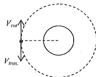
2. En un instante dado un cilindro ( $R = 30 \text{ cm}$ ) se está moviendo. En la figura se muestra una sección del mismo. Las velocidades de dos puntos del cuerpo son  $V_{cm} = -10 \frac{m}{s} \hat{j}$  y  $|V_p| = 20 \frac{m}{s}$ ;  $\alpha = 60^\circ$ . a) verificar el tipo de movimiento que posee el cilindro y su condición de rigidez. b) Hallar analíticamente la posición del CIR.
