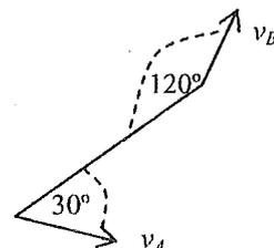
a) para plantear el problema, podemos usar un sistema de referencia con un eje  $x$  paralelo a la varilla, un eje  $y$  perpendicular, y uno  $z$  perpendicular a la mesa (saliente de la hoja)
