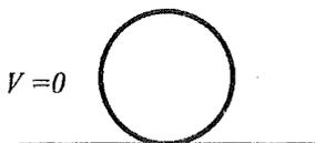
Cuando un cuerpo se mueve sobre una superficie y lo hace sin deslizar, es necesario que el punto de contacto tenga la misma velocidad que el piso (así su movimiento relativo al piso es 0). Esto convierte al punto de contacto en el CIR. Para que se cumpla esta condición es necesario que:  $v_{cm} = \omega R$ , donde  $v_{cm}$  es la velocidad del centro de masa.
